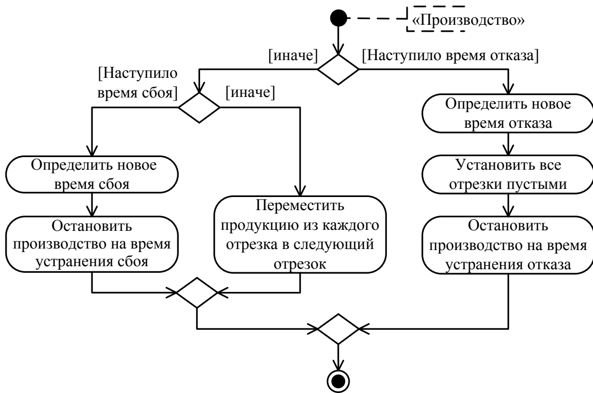
Рисунок 7.9 – Алгоритм стадии «Производство»
