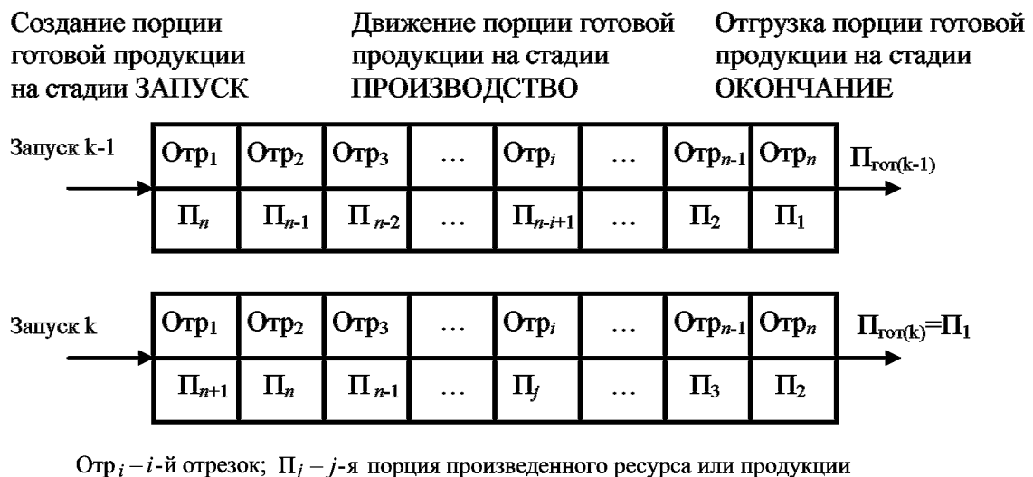
Рисунок 7.8 – Движение ресурсов по отрезкам при выполнении производственной операции
