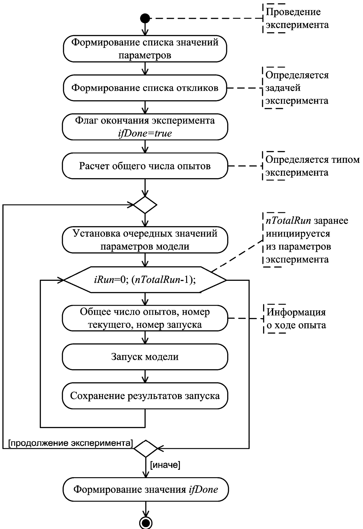
Рисунок 4.11 – Схема алгоритма блока проведения опытов
