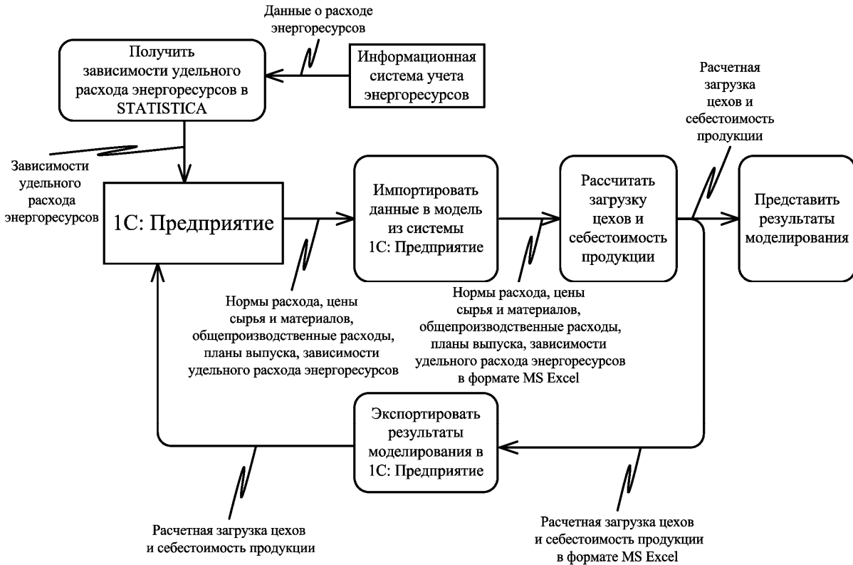
Рисунок 7.14 – Схема автоматизированной технологии обработки информации
