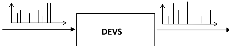
Figura 1.1: Comportamiento E/S de un modelo DEVS con un puerto de entrada y uno de salida.
