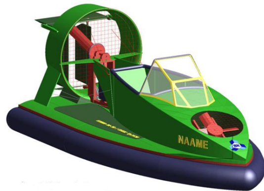
Hình 2: Thiết kế thi công 3D tàu đệm khí.
