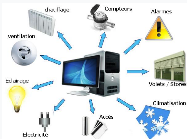
Figure I.2 : Systèmes coopérants de gestion technique dans bâtiment
