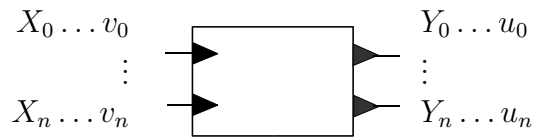
FIG. 3.1 – Représentation graphique d'un modèle DEVS atomique. Les triangles à l'intérieur de la boîte figurent les ports d'entrée. Les triangles à l'extérieur de la boîte figurent les ports de sortie.
