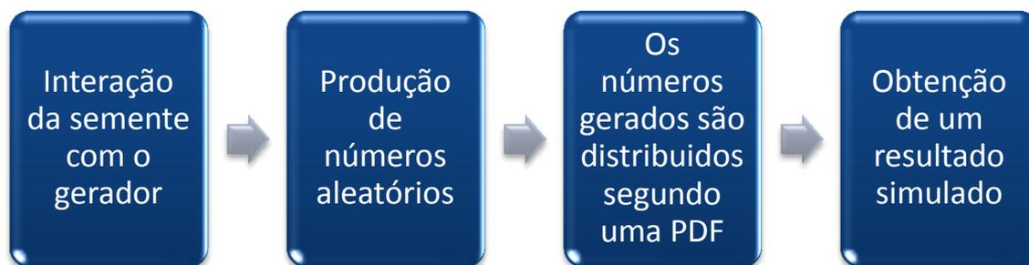
Figura 1: Nesta figura pode-se observar a estrutura elementar simplificada da simulação de MC em que se inicia pela definição de uma semente que começará a produzir os números aleatórios. Estes serão distribuídos, segundo métodos de amostragem, em uma função de densidade de probabilidade (PDF) e então será obtido um resultado oriundo da simulação do fenômeno físico.
