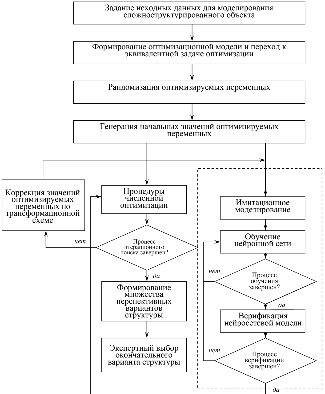
Рис. 3.1. Структура интегрированной вычислительной среды оптимизации, нейросетевого и имитационного моделирования
