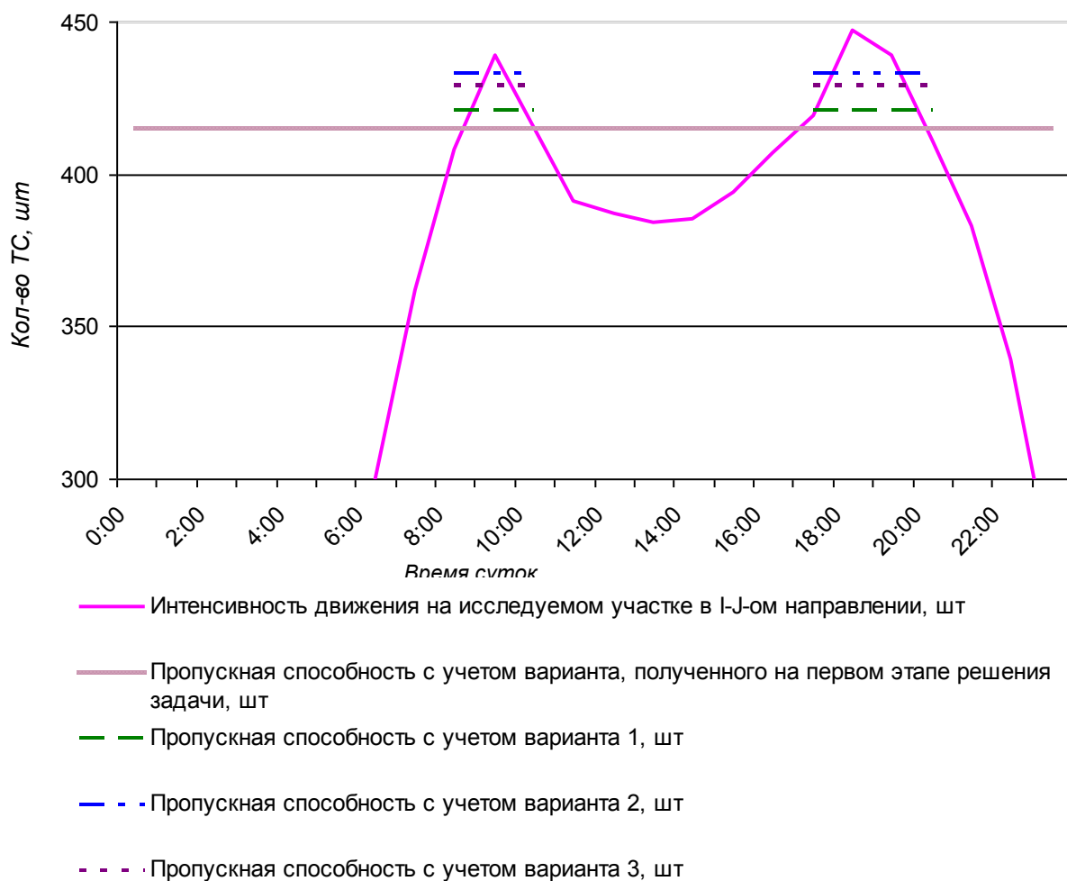
Рис. 4.13. Сравнительные графики пропускной способности перекрестка «Остужевское кольцо» с его среднесуточной загруженностью с учетом возможности динамического режима поиска решений
