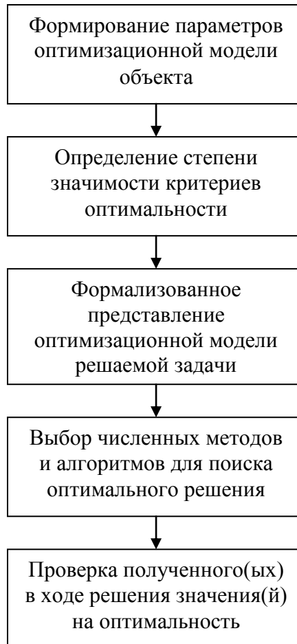
Рис. 1.1. Схема формирования оптимизационной модели и численного решения задачи оптимизации
